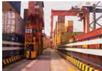
Electric Rubber Tyred Gantry Crane (eRTGC) 電動龍門吊機
